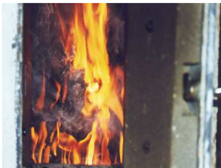
Bild 4 und Bild 5 : Rußbrand im Kamin bei geöffneter Reinigungstür
